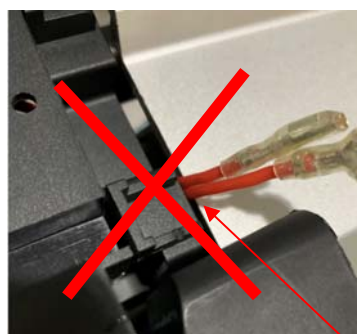
线圈连接线禁止夹在基座和模块中间
